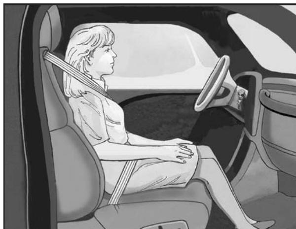
Les ceintures de sécurité contribuent à maintenir le passager en position dans le siège pendant les manoeuvres du véhicule et le freinage. Ceci aide le système de détection de passager à maintenir le statut de sac gonflable de passager. Se reporter à « Ceintures de sécurité » et « Dispositifs de protection d'enfant », dans l'index, pour plus d'information au sujet de l'importance de l'utilisation correct du dispositif de protection d'enfant.
