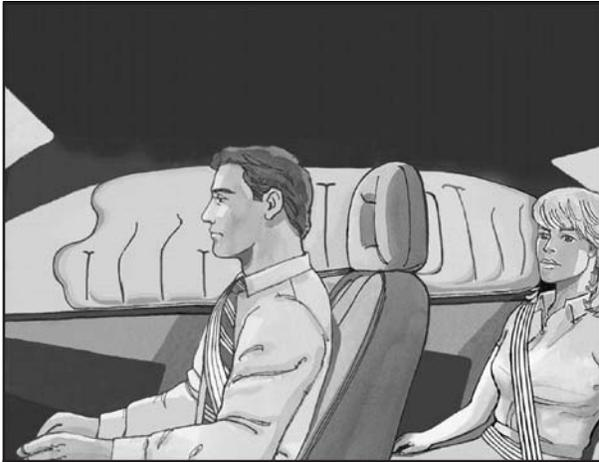
Si votre véhicule est équipé d'un sac gonflable pour capotage de pavillon pour le passager avant droit et la personne directement derrière ce passager, celui-ci se trouve dans le plafond au dessus des glaces latérales.
