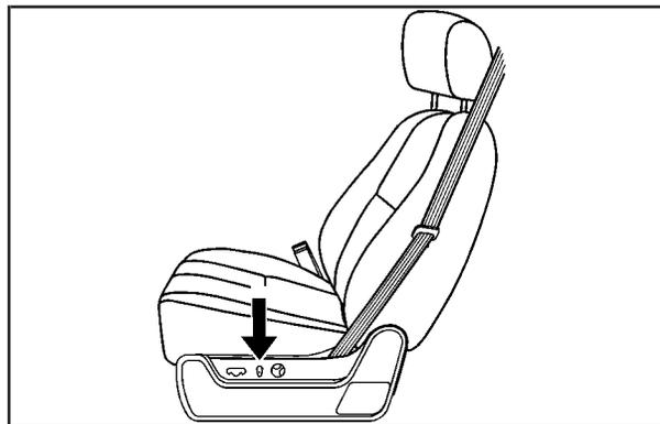
Si les sièges sont équipés de dossiers inclinables à commande électrique, les commandes permettant de les incliner se trouvent sur le côté extérieur du siège derrière la commande de siège électrique.
