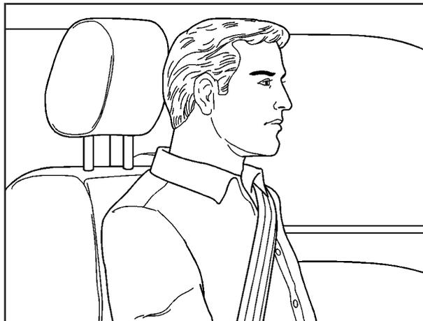
Régler l'appuie-tête de sorte que sa partie supérieure arrive au niveau du haut de la tête de l'occupant. Cette position réduit les risques de blessure à la nuque lors d'une collision.
