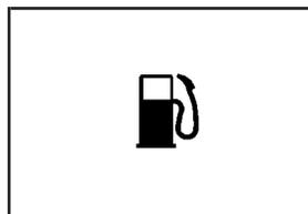
Ce témoin lumineux, situé sous la jauge de carburant, s'allume brièvement lorsque vous démarrez le moteur.
