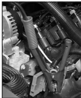
7. Brancher le câble positif (+) rouge à la borne positive (+) du véhicule dont la batterie est déchargée. Utiliser une borne positive (+) auxiliaire si le véhicule en est équipé.
