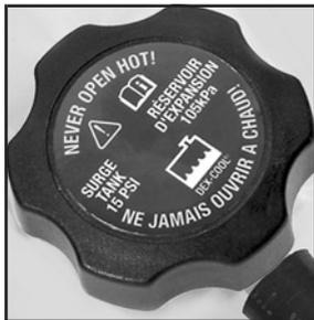
1. Vous pourrez retirer le bouchon de pression du réservoir d'expansion lorsque le système de refroidissement, y compris le bouchon de pression et la durite supérieure, ne sera plus chaud.
