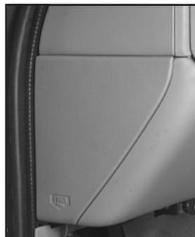
Le volet d'accès au bloc-fusibles se trouve sur le tableau de bord, du côté conducteur. Retirer le couvercle pour avoir accès au bloc-fusibles.
