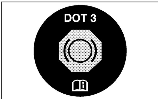
Le réservoir du maître-cylindre des freins est rempli de liquide pour freins DOT 3. Se reporter à la rubrique *Aperçu du compartiment moteur à la page 5-16* pour connaître l'emplacement du réservoir.
