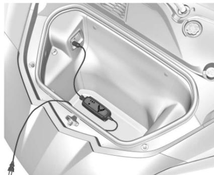
Certains véhicules possèdent un ensemble de maintien de batterie. Respecter le mode d'emploi de l'ensemble de maintien de batterie pour maintenir la batterie chargée lorsque le véhicule n'est pas utilisé. Brancher le dispositif de maintien de batterie dans la prise d'alimentation des accessoires sous le capot uniquement.
