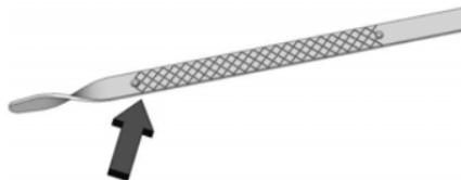
Si l'huile se trouve sous la zone hachurée à l'extrémité de la jauge, ajouter 1 l (1 qt) de l'huile recommandée par l'ouverture du bouchon de remplissage d'huile dans le tube de remplissage du réservoir d'huile, puis vérifier à nouveau le niveau. Voir Sélection de la bonne huile moteur, plus loin dans cette section pour connaître le type d'huile à utiliser. Pour la capacité du carter d'huile moteur, voir *Capacités et spécifications* ⇨ 349.
