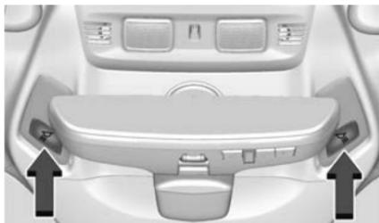
Les lampes de lecture sont dans la console de plafond. Les lampes s'allument lorsque l'une des portes est ouverte, lorsque
