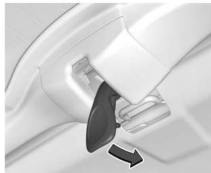
10. Pousser vers l'arrière et vers le haut sur la poignée d'ouverture arrière pour insérer le crochet dans la boucle.
