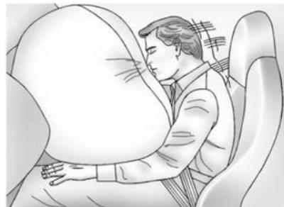
Le sac gonflable avant de passager avant extérieur se trouve dans le tableau de bord du côté passager.
