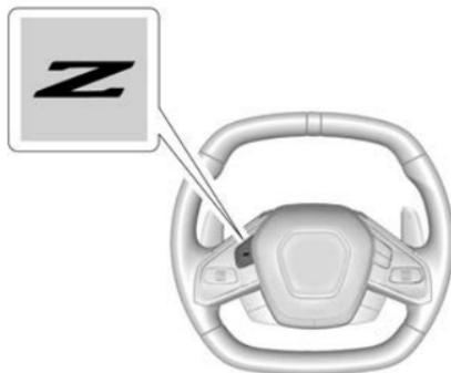
Pour activer le Z-Mode, appuyer sur le bouton Z-Mode du volant. Pour désactiver, le conducteur peut soit sélectionner un autre mode à l'aide du bouton DMC, soit appuyer sur le bouton Z-Mode du volant. Lorsque le Z-mode est désactivé à l'aide du bouton Z-Mode, le DMC est toujours remis en mode Tour.
