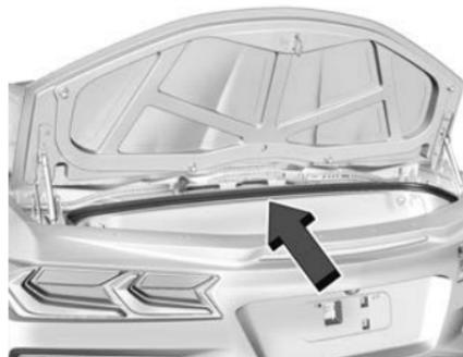
Fermer sans force excessive le hayon/coffre à l'aide de la coupelle de traction, jusqu'à ce que le loquet à commande électrique s'active. Le hayon/coffre parcourt le chemin restant jusqu'à la fermeture et se verrouille automatiquement.
