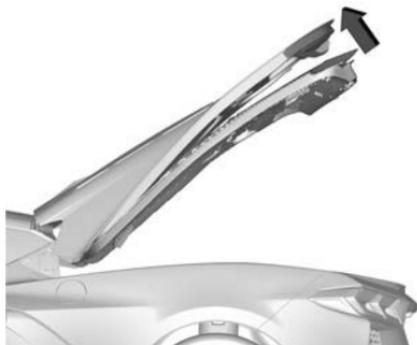
Pour faciliter l'accès au moteur ou au coffre, il est possible de pousser manuellement le hayon/le coffre vers le haut pour obtenir un déplacement supplémentaire. Ne pas appliquer une force excessive.
