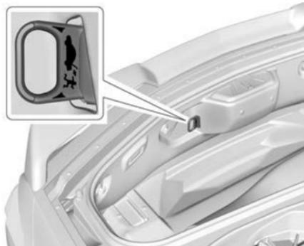
La poignée lumineuse de déverrouillage de secours du hayon/du coffre se trouve sur la paroi intérieure du compartiment de rangement. Cette poignée sera illuminée après une exposition à la lumière. Tirer la poignée de déverrouillage pour ouvrir le coffre depuis l'intérieur du véhicule.
