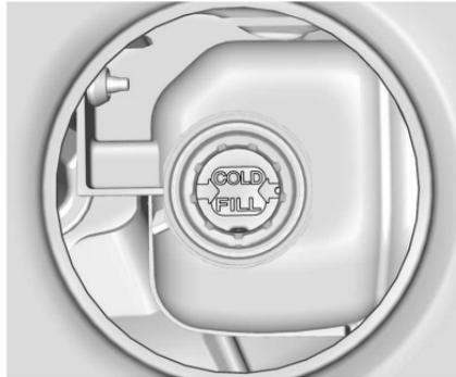
Lorsque le moteur est froid, le niveau de liquide de refroidissement devrait se trouver à l'indicateur COLD FILL dans le réservoir d'appoint de liquide de refroidissement.
