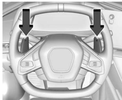
Avec la transmission en D (conduite), appuyer sur le commutateur M (mode manuel) de la console centrale pour passer en mode manuel. Utiliser les palettes sur le volant pour monter ou descendre manuellement les rapports de la boîte de vitesses. Les palettes de droite + (plus) permettent d'augmenter les vitesses, et les palettes de gauche - (moins) de les diminuer.
