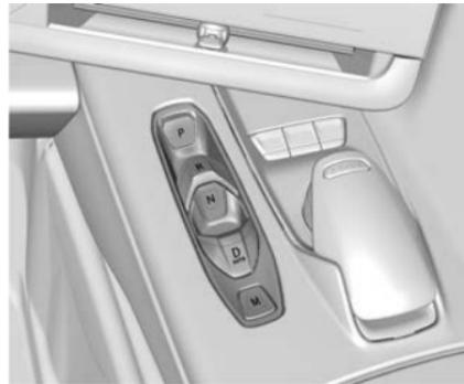
Ce véhicule est équipé d'une transmission à double embrayage qui contient un différentiel arrière intégré. La transmission à double embrayage procure une sensation de connexion extrême grâce à la connexion directe entre le moteur et la boîte de
