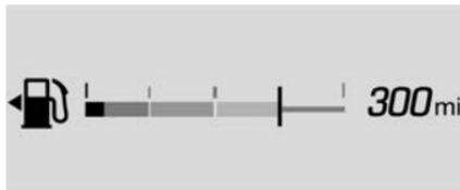
Lorsque le contact est mis, l'indicateur de niveau de carburant signale la quantité approximative de carburant restant dans le réservoir.
