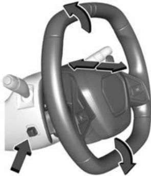
Appuyer sur la commande pour déplacer le volant inclinable et télescopique vers le haut et le bas ou vers l'avant et l'arrière.
