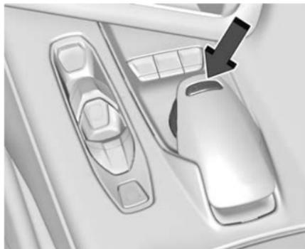
Pour activer les modes My Mode, Météo, Tour, Sport et Piste, tourner la molette de commande de mode conducteur (DMC) de la console centrale pour sélectionner un mode. Lorsqu'un mode est sélectionné, un indicateur s'allume dans le groupe d'instruments et reste allumé.
