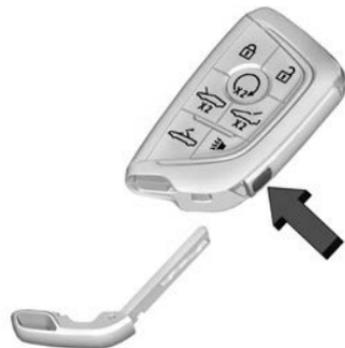
1. Appuyer sur le bouton situé sur le côté de la télécommande et extraire la clé mécanique. Ne jamais retirer la clé mécanique sans appuyer sur le bouton.
