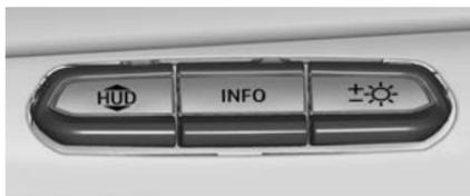
La commande d'affichage tête-haute se trouve sur le tableau de bord à gauche du volant.
