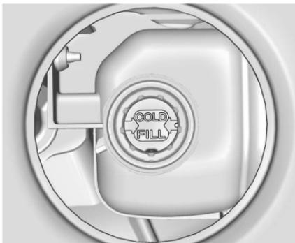
4. Remplir le vase d'expansion de liquide de refroidissement avec le mélange approprié jusqu'à ce que le niveau à l'intérieur se stabilise au niveau de l'indicateur COLD FILL dans le vase d'expansion.
