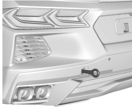
Insérer l'œillet de remorquage dans la douille et le faire tourner jusqu'à ce qu'il soit complètement serré.
