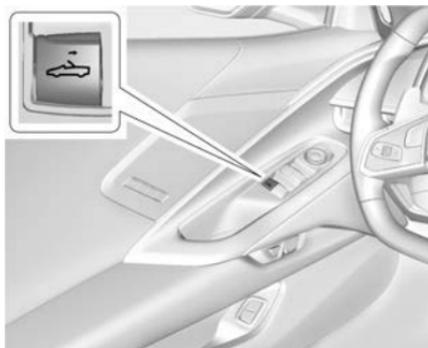
6. Tirer et maintenir
