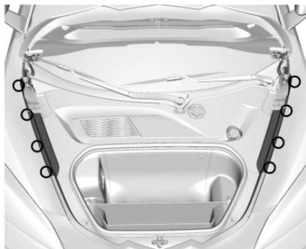
5. Déverrouiller les quatre clips pour les couvercles extérieurs gauche et droit.
