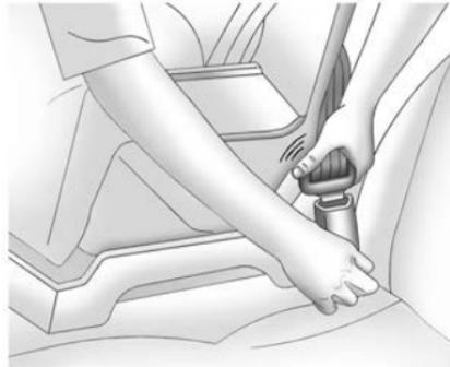
5. Enfoncer la plaque de blocage dans la boucle jusqu'à ce que vous entendiez un dé clic. Positionner le bouton de déblocage de la boucle, à l'écart du siège pour enfants, de manière à pouvoir détacher rapidement la ceinture de sécurité en cas de besoin.
