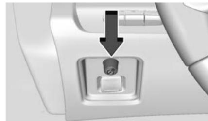
Cette fonction permet de régler la luminosité de toutes les commandes allumées. La molette de cette fonction se trouve sur le côté gauche du tableau de bord.
