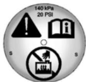
2. Lorsque le système de refroidissement, y compris le bouchon de pression du vase d'expansion et le moteur, a refroidi, retirer le bouchon de pression.
