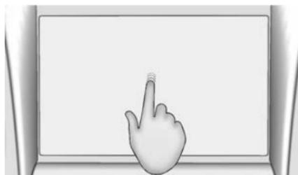
Heurter sert à déplacer des éléments sur une courte distance dans une liste ou une carte. Pour heurter, maintenir et déplacer l'élément sélectionné vers le haut ou vers le bas, vers un nouvel emplacement.
