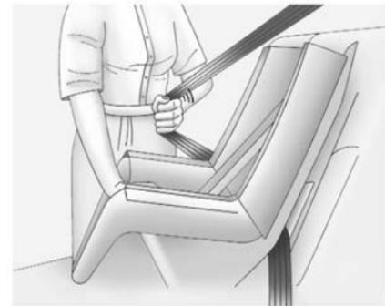
6. Tirer la ceinture diagonale à fond du rétracteur pour enclencher le verrouillage. Lorsqu'il est verrouillé, la ceinture peut être attachée mais non tirée du rétracteur.
