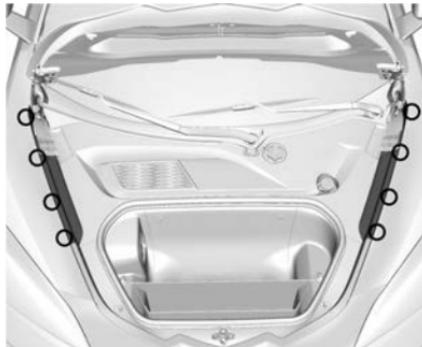
1. Déverrouiller les quatre clips pour les couvercles extérieurs gauche et droit.
