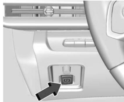
Le frein de stationnement électrique (EPB) peut toujours être serré, même si le contact du véhicule est coupé. En cas d'insuffisance de puissance électrique, l'EPB ne peut pas être serré ou desserré. Pour éviter d'épuiser la batterie, éviter les cycles répétés inutiles d'actionnement de l'EPB.
