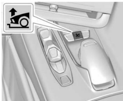
Pour utiliser le système de relevage avant, appuyer sur le bouton de la console centrale pour lever ou abaisser le véhicule. Cette fonction peut être utilisée à des vitesses allant jusqu'à 38 km/h (24 mph) lorsque le moteur est en marche. Le système fonctionne en fonction de l'état ou du mode de fonctionnement du véhicule :
