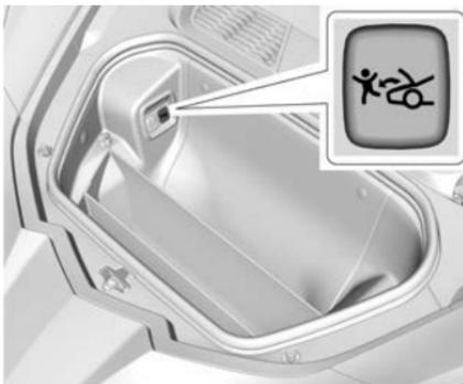
Le compartiment moteur est équipé d'un bouton de déverrouillage de secours de la capote qui brille dans le noir. Ce bouton s'illumine après une exposition à la lumière. Appuyer sur le bouton pour ouvrir le capot depuis l'intérieur du compartiment moteur.
