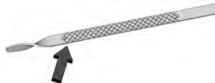
Si l'huile se trouve sous la zone hachurée à l'extrémité de la jauge, ajouter 1 l (1 qt) de l'huile recommandée par l'ouverture du bouchon de remplissage d'huile dans le tube de remplissage du réservoir d'huile, puis vérifier à nouveau le niveau. Voir Sélection de la bonne huile moteur, plus loin dans cette section pour connaître le type d'huile à utiliser. Pour la capacité du carter d'huile moteur, voir *Capacités et spécifications* ⇨ 359.
