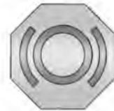
Le réservoir de maître-cylindre de frein est rempli de liquide pour frein DOT 4 homologué par GM, comme indiqué sur le bouchon du réservoir. Se reporter à *Aperçu du compartiment moteur* ↪ 256 pour connaître l'emplacement du réservoir.
