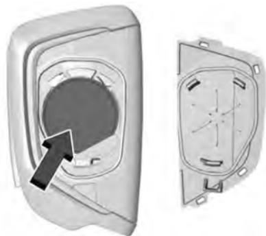
3. Retirer le joint en tirant sur la languette pour accéder à la pile.
