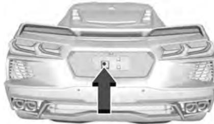
Utiliser la clé mécanique dans le cylindre de clé de secours derrière la plaque d'immatriculation pour ouvrir manuellement le hayon/le coffre. La plaque d'immatriculation doit être retirée.
