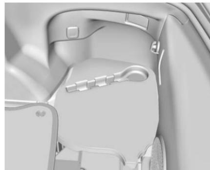
L'œillet de remorquage peut être rangé dans le véhicule, dans la zone de coffre côté passager, sous le tapis.
