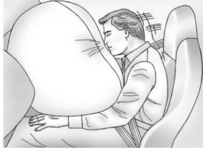
Le sac gonflable avant de passager avant extérieur se trouve dans le tableau de bord du côté du passager.
