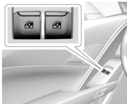
Les lève-glaces électriques fonctionnent lorsque le contact est mis, en position ACC/ACCESSORY (accessoires) ou lorsque la prolongation de l'alimentation des accessoires (RAP) est active. Voir *Prolongation d'alimentation des accessoires* ⇨ 214.
