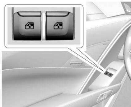
Les lève-vitres électriques fonctionnent lorsque le véhicule est en marche ou sur ACC/ACCESSORY (accessoires) ou lorsque la prolongation de l'alimentation des accessoires (RAP) est active. Se reporter à *Prolongation d'alimentation des accessoires* ⇨ 214.
