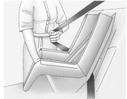
5. Tirer la ceinture diagonale à fond du rétracteur pour enclencher le verrouillage. Lorsqu'il est verrouillé, la ceinture peut être attachée mais non tirée du rétracteur.
