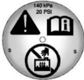
1. Lorsque le système de refroidissement, y compris le bouchon de pression et la durite supérieure, a refroidi, retirer le bouchon de pression.
