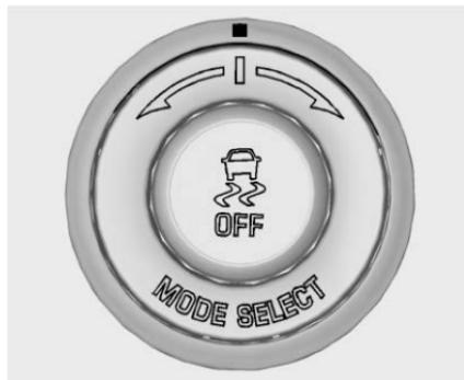
Pour sélectionner ce mode en option, le véhicule doit être en mode Sport ou Circuit. Pour les véhicules équipés de la gestion de traction de performance (PTM), le mode de conduite sportive est seulement disponible en mode Sport. Pour les
