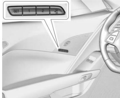
Selon l'équipement, les sièges à mémoire de position permettent à deux conducteurs de sauvegarder et rappeler, leurs positions individuelles de siège pour conduire le véhicule, et une position commune de sortie pour quitter le véhicule. Les positions d'autres dispositifs à mémoire tels que les rétroviseurs à commande électriques et le volant de direction à commande électrique peuvent également être sauvegardées, selon l'équipement. Les positions mémorisées sont associées à
