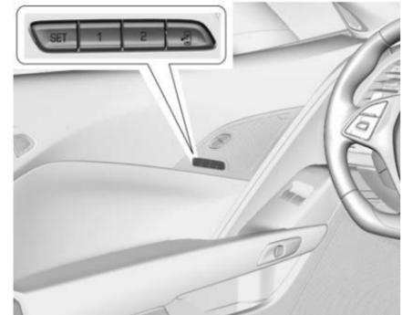
Selon l'équipement, les sièges à mémoire permettent à deux conducteurs de sauvegarder leur propre position du siège pour conduire le véhicule, ainsi qu'une position commune de sortie du véhicule. La position d'autres accessoires peut également être sauvegardée, comme les rétroviseurs à commande électrique et la direction assistée, selon l'équipement. Les positions en mémoire sont reliées à l'émetteur RKE 1 ou 2 pour des rappels de mémoire automatiques.
