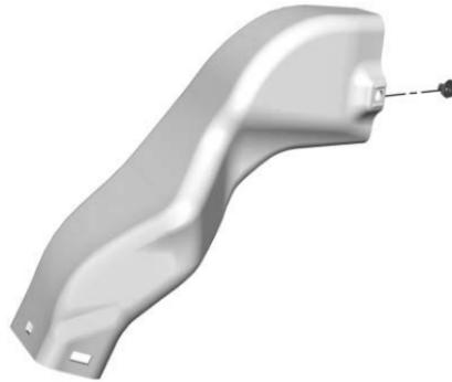
7. Positionner l'écrou à pincer sur la conduite supérieure.
