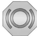
Le réservoir de maître-cylindre de frein est rempli de liquide pour frein DOT 3 homologué par GM, comme indiqué sur le bouchon du réservoir. Se reporter à *Aperçu du compartiment moteur* ↻ 252 pour connaître l'emplacement du réservoir.
