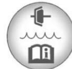
Le bouchon du réservoir du liquide d'embrayage hydraulique arbore ce symbole. Se reporter à la rubrique *Aperçu du compartiment moteur* ⇨ 252 pour connaître l'emplacement du réservoir.
