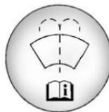
Retirer le bouchon marqué du symbole de liquide de lave-glace. Ajouter du liquide jusqu'à ce que le réservoir soit plein. Se reporter à *Aperçu du compartiment moteur* ↻ 252.
