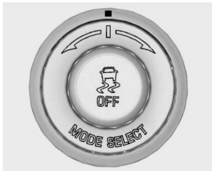
Le système PTM contient cinq modes. Ces modes sont sélectionnés en faisant tourner le bouton de gestion de commande sélective de suspension/traction de performance MODE SELECT sur la console centrale. Défiler vers le haut ou le bas à travers les modes 1–5 en faisant tourner le bouton MODE SELECT vers la droite ou la gauche.
