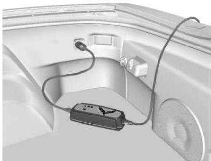
Certains véhicules possèdent un ensemble de maintien de batterie. Respecter le mode d'emploi de l'ensemble de maintien de batterie pour maintenir la batterie chargée lorsque le véhicule n'est pas utilisé. Brancher le dispositif de maintien de batterie dans la prise arrière d'alimentation des accessoires uniquement. La prise électrique avant n'est plus sous tension lorsque le contact est coupé.
