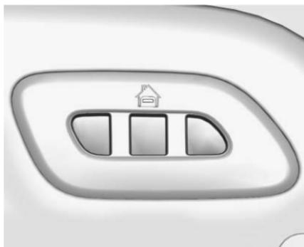
Si le véhicule en est équipé, ce système permet de remplacer jusqu'à trois télécommandes utilisées pour activer des dispositifs tels qu'une porte de garage, un système de sécurité et un éclairage de la maison.
