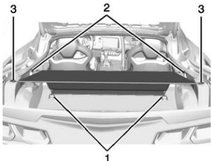
1. Fixer les boucles en plastique du cache-bagage aux attaches de plancher (1) et aux panneaux latéraux (2).
