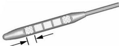
Si le niveau d'huile se situe au-dessous de la section quadrillée de la pointe de la jauge et que le moteur est éteint depuis au moins 15 minutes, ajouter un litre d'huile (1 pt) préconisée et vérifier encore le niveau. Se reporter à « Choisir l'huile moteur appropriée » plus loin dans ce chapitre pour obtenir des explications sur le type d'huile à utiliser. Pour la capacité d'huile moteur du carter, se reporter à *Capacités et spécifications* ▷ 373.
