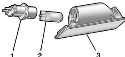
3. Faire tourner la douille d'ampoule (1) dans le sens inverse des aiguilles d'une montre pour la retirer de l'ensemble de lampe (3).
