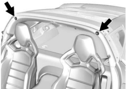
5. Placer l'arrière du panneau de pavillon sur le profilé d'étanchéité à l'arrière de l'ouverture du toit. Ensuite, aligner et mettre en place les axes à l'arrière du panneau de pavillon dans les ouvertures des profils d'étanchéité arrière. Abaisser doucement la partie avant du panneau de pavillon sur le devant de l'ouverture du toit.
