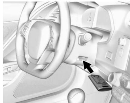
8. Mettre le nouvel émetteur dans la pochette d'émetteurs de la colonne de direction en orientant les boutons vers le haut et le dessous du transmetteur vers le côté passager.
