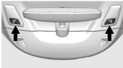
Les lampes de lecture se trouvent sur la console de plafond. Elles s'allument lorsqu'une porte est ouverte. Tt ouverte. Lorsque les portes sont fermées, appuyer sur les boutons des lampes pour allumer chaque lampe.
