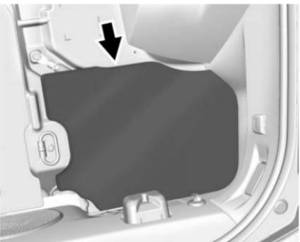
5. Retirer l'œillet gauche du cache-bagages, ensuite déposer le couvercle de la batterie et localiser les cosses positive (+) et négative (-).
