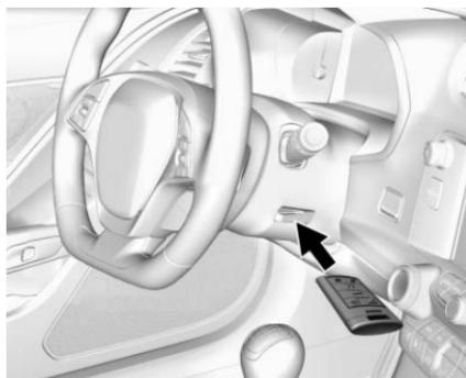
1. Mettre l'émetteur dans la pochette d'émetteurs de la colonne de direction en orientant les boutons vers le haut et le dessous de l'émetteur vers le côté passager.
