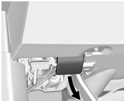
1. Tirer sur le levier de déverrouillage du capot à l'intérieur du véhicule. Il se trouve sous le tableau de bord, du côté conducteur.
