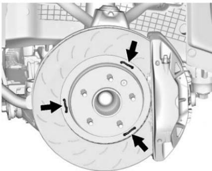
9. Vérifier si les bagues de disques et le fil de sécurité n'entrent pas en contact avec d'autres organes.
