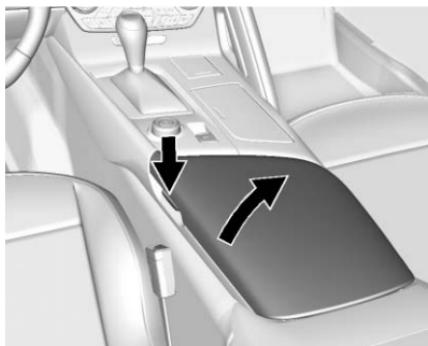
Pour l'ouvrir, appuyer sur le bouton du côté conducteur.
