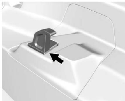
2. Insérer l'avant du panneau de pavillon afin que les encoches s'appuient sur le dessus des récepteurs.
