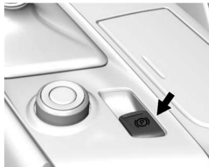
Le véhicule est équipé d'un frein électrique de stationnement (EPB). Le commutateur se trouve sur la console centrale. L'EPB peut toujours être activé, même si le contact est coupé. Pour éviter la décharge de la batterie, éviter d'actionner l'EPB de manière répétitive lorsque le moteur est arrêté.
