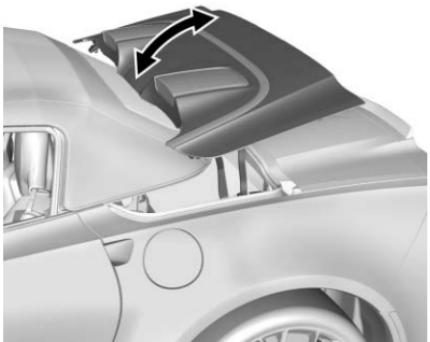
1. De chaque côté du couvre-capote, soulever et faire tourner vers l'arrière jusqu'en position entièrement ouverte.
