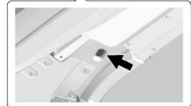
Utiliser uniquement un cric de service avec un diamètre de patin de levage de 64 mm (2,5 po) ou moins et d'une épaisseur suffisante pour que le cric n'entre pas en contact avec la carrosserie du véhicule.
