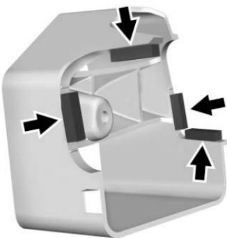
5. Retirer la bande adhésive des coussinets en caoutchouc, puis les poser sur la boîte à air avant, comme illustré. Laisser sécher pendant 5 minutes.
