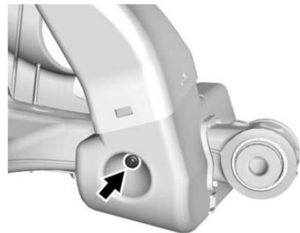
12. Fixer les deux vis autotaraudeuses au bras de suspension des deux côtés des cavités de la boîte à air. Ne pas serrer tout de suite.
