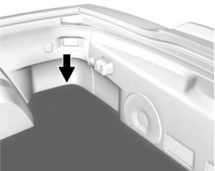
4. Ouvrir le hayon/coffre et lever la moquette du côté passager du véhicule pour accéder au couvercle de la batterie.
