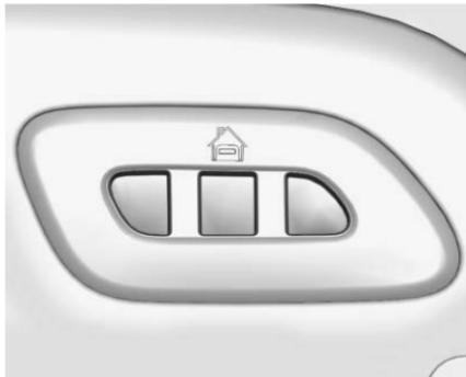
Si le véhicule en est équipé, ces boutons se trouvent dans le pare-soleil du conducteur.
