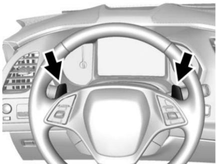
Le système de changement de rapport manuel par palettes peut être utilisé en mode conduite (D) et en mode manuel (M). Le système s'active lorsqu'on appuie sur la manette gauche pour rétrograder et sur la manette droite pour passer la vitesse supérieure. Le rapport actuel s'affiche dans le groupe d'instruments ou sur l'affichage tête-haute (HUD), si le véhicule en est équipé.
