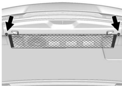
Le véhicule peut être équipé d'un filet d'arrimage utilisé pour les petits objets. Fixer le filet aux crochets arrière de l'aire de chargement. Il ne faut pas utiliser le filet pour ranger des objets lourds.
