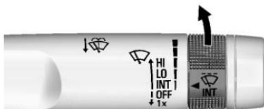
**INT** : Placer le levier jusqu'à la position INT pour des balayages intermittents, puis faire tourner la bande INT vers le haut pour augmenter la fréquence des balayages ou vers le bas pour diminuer cette fréquence.
