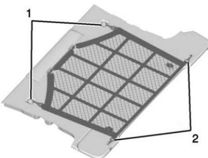
Si le véhicule en est équipé, déplier le filet d'arrimage et fixer les crochets avant (1) aux points d'arrimage avant dans l'espace de chargement. Tirer le filet de manière à recouvrir les objets entreposés sur
