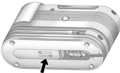
Votre nécessaire d'enduit d'étanchéité et de compresseur est pourvu d'un adaptateur d'accessoires situé dans un compartiment à la base du boîtier, qui peut être utilisé pour gonfler des matelas pneumatiques, des ballons, etc.
