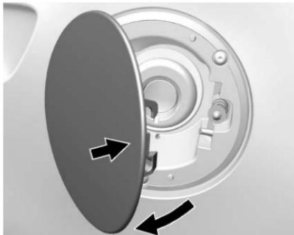
Pour ouvrir la trappe à carburant, pousser et relâcher le bord arrière central du volet. La trappe à carburant est verrouillée lorsque les portes du véhicule sont verrouillées.
