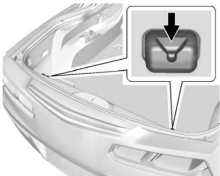
3. Aligner les goupilles arrière du panneau de pavillon afin qu'elles s'insèrent dans les récepteurs situés à l'arrière de l'espace de chargement.
