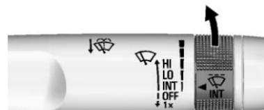
**INT** : Placer le levier en position INT pour des balayages intermittents, puis tourner la bande INT vers le haut pour augmenter la fréquence des balayages ou vers le bas pour la diminuer.
