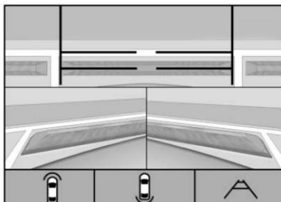
Selon l'équipement, une vue de la zone avant du véhicule s'affiche à l'écran du système infodivertissement. Une vue de l'avant vu de dessus s'affiche au bas de l'écran sur les images du haut et de gauche et droite de la caméra avant.
