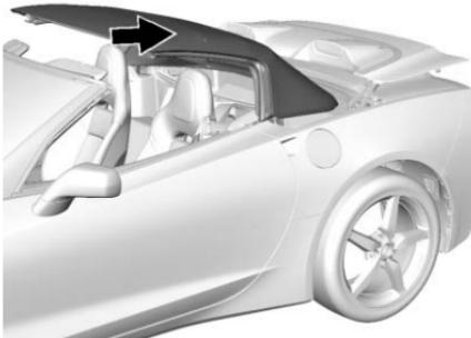
2. Soulever et faire tourner le toit décapotable vers l'arrière jusqu'en position entièrement rangée.
