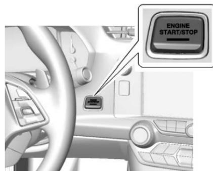
Votre véhicule est équipé d'un bouton-poussoir de démarrage électronique sans clé.
