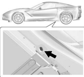
Utiliser uniquement un cric de service avec un diamètre de patin de levage de 64 mm (2,5 po) ou moins et d'une épaisseur suffisante pour que le cric n'entre pas en contact avec la carrosserie du véhicule.
