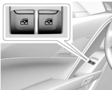
Les glaces fonctionnent lorsque le contact est en position ON/RUN (marche) ou ACC/ACCESSORY (accessoires), ou lorsque la Prolongation de l'alimentation des accessoires (RAP) est activée. Se reporter à *Prolongation d'alimentation des accessoires* ▷ 217.
