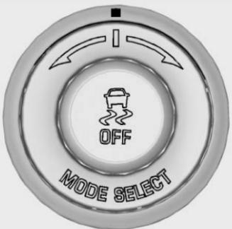
Le système PTM contient cinq modes. Ces modes sont sélectionnés en faisant tourner le bouton de gestion de commande sélective de suspension/traction de performance MODE SELECT sur la console centrale. Défiler vers le haut ou le bas à travers les modes 1–5 en faisant tourner le bouton MODE SELECT vers la droite ou la gauche.
