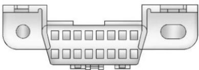
Le connecteur de liaison de données (DLC) se trouve sous le tableau de bord, à gauche du volant de direction. Le fait de connecter des dispositifs qui ne sont pas utilisés pour effectuer un essai d'inspection des émissions/de maintenance ou d'entretenir le véhicule peut affecter son fonctionnement. Se reporter à *Équipement électrique complémentaire* ▷ 255. Contacter votre concessionnaire si une assistance est nécessaire.
