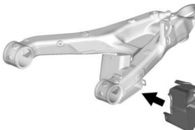
8. Positionner les boîtes à air arrière et avant autour du bras de suspension inférieur en commençant par la boîte à air arrière. Enclencher les languettes.
