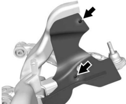
11. Fixer le déflecteur du bras de suspension au bras de suspension inférieur avec les vis autotaraudeuses. Ne pas serrer tout de suite.
