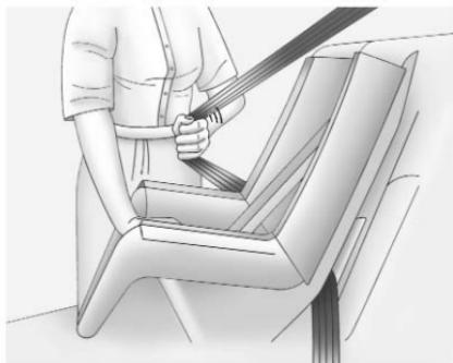
5. Tirer la ceinture diagonale à fond du rétracteur pour enclencher le verrouillage. Lorsqu'il est verrouillé, la ceinture peut être attachée mais non tirée du rétracteur.
