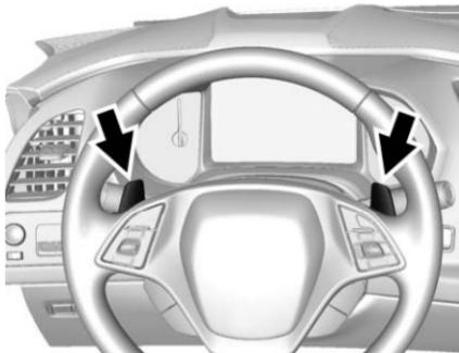
Lorsque le levier de changement de rapport est déplacé en mode manuel (M), le mode manuel est activé. La boîte de vitesses maintient le rapport actuel jusqu'à ce qu'un changement soit nécessaire. Les palettes au volant peuvent être utilisées pour changer le rapport vers le haut ou le bas manuellement. La palette du côté droit (+) permet de passer au
