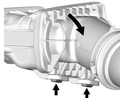
5. Faire tourner vers le bas le filtre à air/capuchon d'extrémité et dégager les onglets de montage du capuchon d'extrémité inférieur des fixations de charnière de retenue inférieure. Introduire complètement les onglets de montage de capuchon d'extrémité inférieur dans les éléments de charnière de retenue du boîtier avant de
