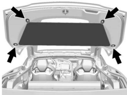
Fixer les boucles élastiques aux quatre coins du cache-bagages sur les crochets des coins avant et arrière.
