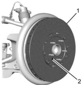
8. Poser le disque (1) à l'aide de la fixation (2). Serrer à 10 N·m (89 lb-po).
