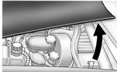
2. Aller sur le côté du véhicule et soulever le rebord arrière du capot, près du pare-brise.
