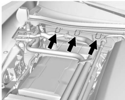
1. Ouvrir les agrafes de retenue du couvercle du filtre à air de l'habitacle. Les flexibles PVC doivent parfois être écartés brièvement pour accéder au couvercle du filtre à air.
