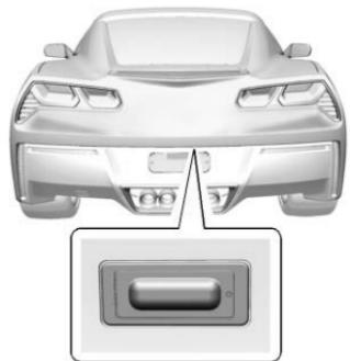
Appuyer sur le pavé tactile d'ouverture du hayon/coffre pour ouvrir le coffre si l'émetteur de télédéverrouillage (RKE) se trouve à moins de 1 m (3 pi).
