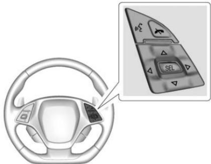
Utiliser la commande du volant du côté droit pour ouvrir et parcourir les différents éléments et affichages.
