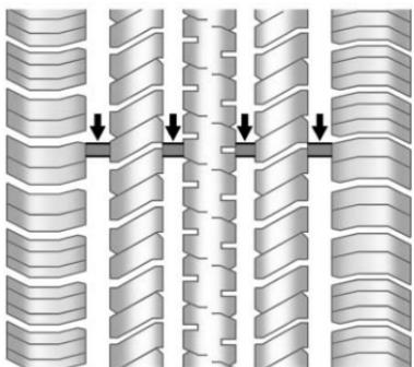
Les témoins d'usure de la bande de roulement sont un moyen de savoir à quel moment il est nécessaire de changer les pneus. Les témoins d'usure apparaissent lorsque la bande de roulement restante est inférieure ou égale à 1,6 mm (1/16 po). Se reporter à *Inspection des pneus* ▷ 322 et *Permutation des pneus* ▷ 322.
