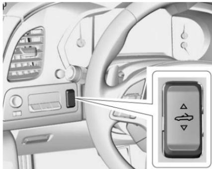
5. Maintenir enfoncée la partie inférieure de . Les vitres s'ouvrent automatiquement.
