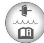
Le bouchon du réservoir du liquide d'embrayage hydraulique arbore ce symbole. Se reporter à la rubrique *Aperçu du compartiment moteur* ▷ 263 pour connaître l'emplacement du réservoir.
