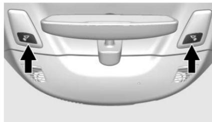
Les lampes de lecture se trouvent dans la console suspendue. Les lampes s'allument lorsqu'une porte
