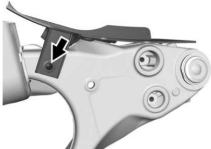
10. Fixer le déflecteur du bras de suspension à la conduite supérieure avec l'écrou. Ne pas serrer tout de suite.
