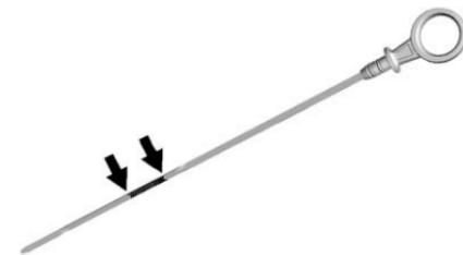
Si le niveau d'huile se situe au-dessous de la section quadrillée de la pointe de la jauge, ajouter 1 litre (1 quart) d'huile préconisée dans le réservoir d'huile par le goulot de remplissage et vérifier encore le niveau. Se reporter à « Choisir l'huile moteur appropriée » pour obtenir des explications sur le type d'huile à utiliser. Pour la capacité d'huile moteur du carter, se reporter à *Capacités et spécifications* ▷ 373.
