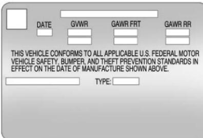
Une étiquette de conformité spécifique du véhicule est apposée sur le bord arrière de la porte conducteur. Elle peut indiquer le poids brut autorisé du véhicule, appelé Poids nominal brut du véhicule (PNBV). Le PNBV comprend le poids du véhicule, tous les occupants, le carburant et le chargement.
