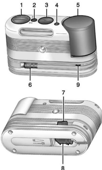
1. Commutateur de sélection (enduit/air ou air uniquement)
