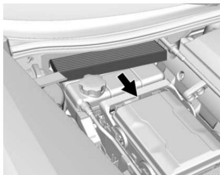
3. Déposer le filtre et installer le nouveau filtre à air.
