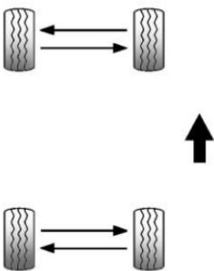
Utiliser ce schéma de permutation si le véhicule est équipé de pneus de tailles différentes à l'avant et à l'arrière.
