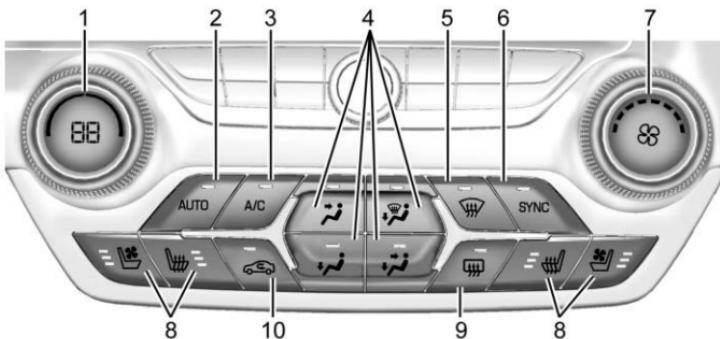
1. Commande de la température côté conducteur
