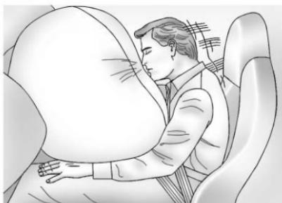
Le sac gonflable avant de passager avant extérieur se trouve dans le tableau de bord du côté passager.
