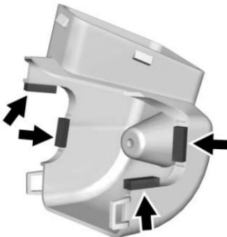
6. Retirer la bande adhésive des coussinets en caoutchouc, puis les poser sur la boîte à air arrière, comme illustré. Laisser sécher pendant 5 minutes.
