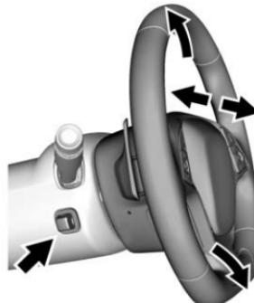
Appuyer sur la commande pour placer le volant inclinable et télescopique vers le haut et vers le bas, ou vers l'avant et vers l'arrière.
