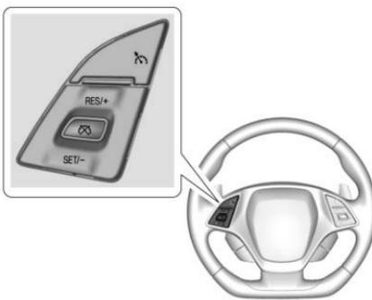
: Appuyer pour activer ou désactiver le régulateur de vitesse automatique. Un témoin blanc s'allume dans le groupe d'instruments lorsque le régulateur de vitesse automatique est activé.
