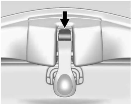
7. Appuyer sur le bouton à l'avant de la poignée de déblocage arrière pour la déverrouiller. Le levier de loquet s'ouvre.
