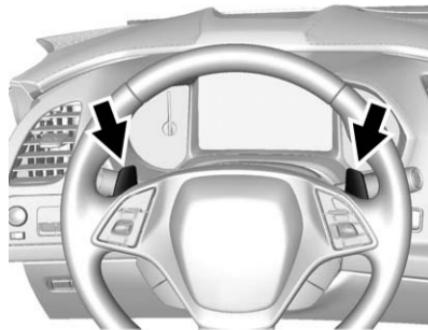
Le système est activé et désactivé en appuyant sur les palettes marquées REV MATCH du volant. Le système doit être activé à chaque nouveau cycle d'allumage.
