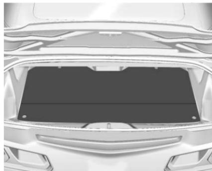
Lorsque le toit décapotable est fermé, il est possible de dégager la cloison et de l'étendre pour augmenter l'espace de chargement du coffre.
