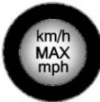
16. Si vous avez réussi à gonfler le pneu à la pression de gonflage recommandée, retirer l'étiquette de vitesse maximale de la cartouche d'enduit d'étanchéité (5) et la placer à un endroit bien visible. Ne pas dépasser la vitesse indiquée sur l'étiquette tant que le pneu n'a pas été réparé ou remplacé.
