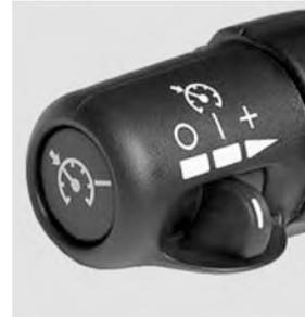
Les commandes du régulateur de vitesse à commande adaptative se trouvent à l'extrémité du levier multifonction.
