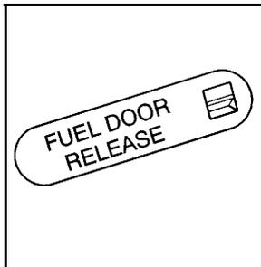
Il y aussi une languette de déverrouillage manuelle du volet d'accès au réservoir de carburant. Elle se trouve contre la garniture supérieure du compartiment arrière du côté du conducteur. Tirer la languette pour ouvrir le volet.
