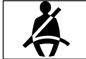
Le témoin de rappel de bouclage de ceinture de sécurité s'allume et reste allumé pendant quelques secondes, puis clignote pendant quelques secondes de plus.
