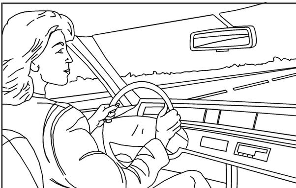
Une telle situation d'urgence nécessite une grande attention et une prise de décision rapide. Si vous tenez le volant aux positions 9 et 3 heures recommandées, vous pouvez le tourner très rapidement de 180 degrés complets en gardant les deux mains sur le volant.
