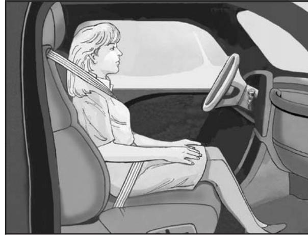
Les ceintures de sécurité contribuent à maintenir le passager en position dans le siège pendant les manoeuvres du véhicule et le freinage. Ceci aide le système de détection de passager à maintenir le statut de sac gonflable de passager. Se reporter à « Ceintures de sécurité » et « Dispositifs de protection d'enfant », dans l'index, pour plus d'informations au sujet de l'importance de l'utilisation correct du dispositif de protection d'enfant.
