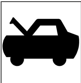
1. Tirer sur le levier d'ouverture du capot portant ce symbole. Il se trouve à l'intérieur du véhicule sous le tableau de bord, du côté conducteur.
