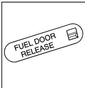
Il y a aussi une languette de déverrouillage manuelle du volet d'accès au réservoir de carburant. Elle se trouve contre la garniture supérieure du compartiment arrière du côté du conducteur. Tirer la languette pour ouvrir le volet.
