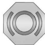
Ce symbole figure sur le bouchon du réservoir de liquide de frein/embrayage hydraulique. Voir *Aperçu du compartiment moteur* ⇨ 274 pour l'emplacement du réservoir. Le réservoir hydraulique commun de liquide de maître-cylindre d'embrayage et de frein est rempli de liquide de frein comme indiqué sur le bouchon. Voir *Liquide de frein* ⇨ 294 pour le liquide de frein à utiliser.
