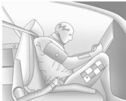
Dans un véhicule en mouvement, vous vous déplacez à la vitesse du véhicule. Si le véhicule s'arrête brutalement, vous êtes emporté jusqu'à ce que quelque chose vous arrête. Ce peut être le pare-brise, le tableau de bord ou les ceintures de sécurité!
