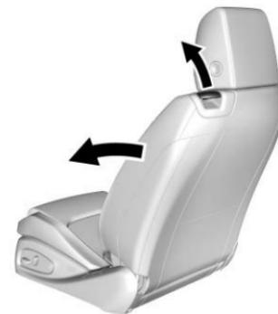
Pour accéder aux sièges arrière lever le loquet placé en haut du dossier de siège de conducteur ou de passager avant. Replier le dossier de siège vers l'avant.
