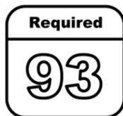
Utiliser de l'essence super sans plomb conforme à la norme D4814 de l'ASTM avec un indice d'octane de 93 — (R+M)/2. Si ce type d'essence n'est pas disponible, il est possible d'utiliser de l'essence sans plomb avec un indice d'octane de 91. Cela réduira cependant le rendement et l'économie de carburant. L'utilisation d'essence avec un indice d'octane inférieur à 91 peut endommager le moteur, et ces réparations ne sont pas couvertes par la garantie du véhicule. Si des cliquetis bruyants
