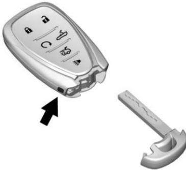
La clé à l'intérieur de l'émetteur de télédéverrouillage (RKE) peut être utilisée dans toutes les serrures.
