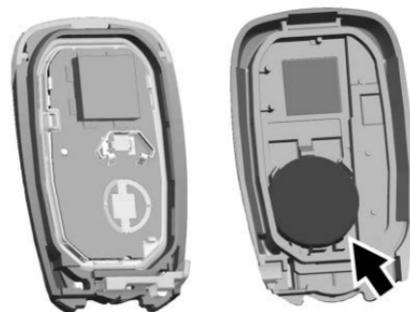
3. Retirer la pile en appuyant dessus et en la faisant glisser vers le bas de l'émetteur.
