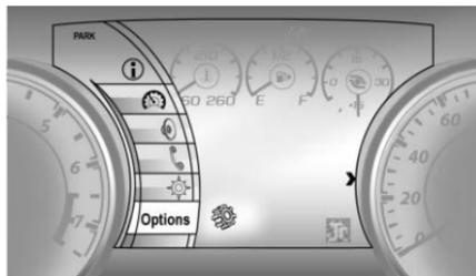
1. En utilisant les boutons situés sur la droite du volant, presser  $\triangleleft$  pour ouvrir le menu du CIB de niveau supérieur. Utiliser  $\nabla$  pour faire défiler jusqu'à Options et presser SEL.
