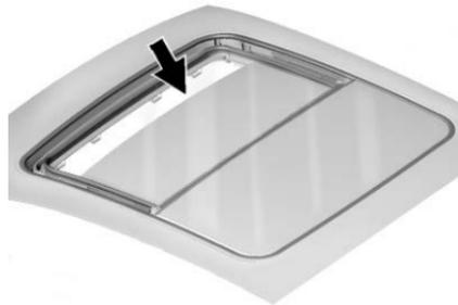
Des saletés et débris peuvent s'accumuler sur le joint d'étanchéité ou dans les glissières et peuvent causer un problème de fonctionnement du toit ouvrant, du bruit ou l'obturation du système d'évacuation d'eau. Ouvrir le toit ouvrant périodiquement et enlever tout obstacle ou débris. Essuyer le joint et les surfaces d'étanchéité du toit ouvrant à l'aide d'un chiffon propre, de savon doux et d'eau. Ne pas enlever la graisse du toit ouvrant.
