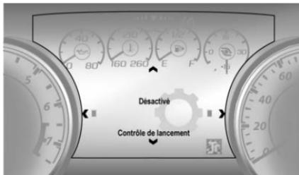
S'assurer que le frein de stationnement est désengagé pour réactiver le contrôle de lancement.
