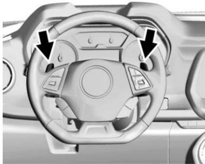
Le système est activé et désactivé en appuyant sur les palettes marquées REV MATCH du volant. Le système doit être activé à chaque nouveau cycle d'allumage.
