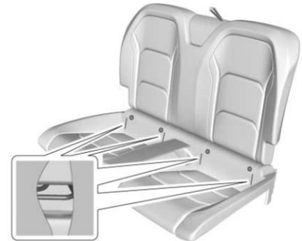
Les ancrages extérieurs et inférieurs se trouvent derrière les ouvertures verticales de la garniture de siège.
