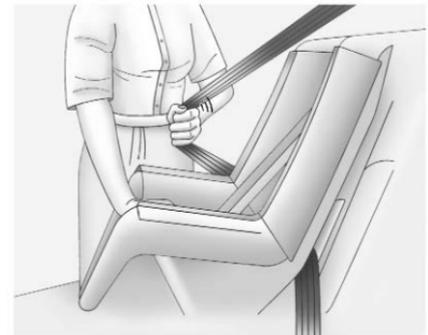
4. Tirer la ceinture diagonale à fond du rétracteur pour enclencher le verrouillage. Lorsqu'il est verrouillé, la ceinture peut être attachée mais non tirée du rétracteur.
