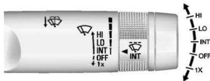
Le levier d'essuie-glace/lave-glace avant est sur le côté droit de la colonne de direction. Le contact étant mis ou en mode ACC/ACCESSORY (accessoires), déplacer le levier pour sélectionner la vitesse de balayage.
