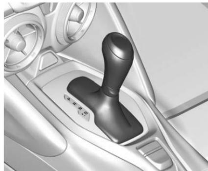
La fonction DSC permet de changer les rapports d'une boîte de vitesses automatique de la même façon qu'avec une boîte de vitesses manuelle. Pour utiliser la fonction DSC :
