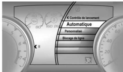
3. Utiliser  $\triangleright$  pour ouvrir le menu Contrôle de lancement. Sélectionner Automatique ou Personnalisé.
