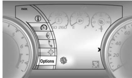
1. En utilisant les boutons situés sur la droite du volant, presser ◀ pour ouvrir le menu du CIB de niveau supérieur. Utiliser ▼ pour faire défiler jusqu'à Options et presser SEL.
