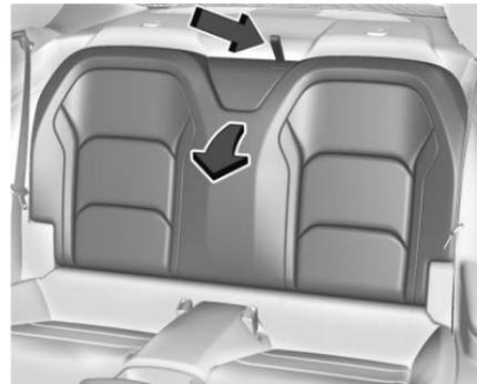
Tirer la boucle au centre du dossier de siège arrière. Le dossier de siège arrière se rabat.
