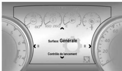
2. Utiliser  $\triangle$  ou  $\nabla$  pour naviguer jusqu'au menu Contrôle de lancement.
