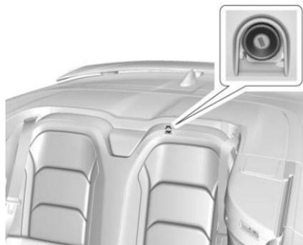
2. Localiser le dispositif d'ouverture manuelle à côté du coussin de siège arrière du côté du conducteur.
