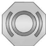
Le réservoir du maître-cylindre de frein/embrayage est rempli de liquide pour frein DOT 4 approuvé par GM, comme indiqué sur le bouchon du réservoir. Se reporter à *Aperçu du compartiment moteur* ⇨ 274 pour connaître l'emplacement du réservoir.
