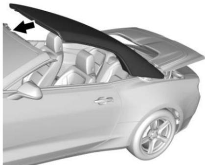
2. Soulever et faire glisser la capote en tirant de chaque côté du cadre avant vers l'avant, jusqu'à la position de fermeture complète.
