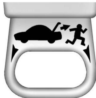
Il existe une poignée lumineuse de déverrouillage d'urgence sur le couvercle du coffre. Cette poignée sera illuminée après une exposition à la lumière. Tirer la poignée de déverrouillage pour ouvrir le coffre depuis l'intérieur du véhicule.
