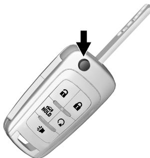
Appuyer sur le bouton de libération de clé (key release) de l'émetteur RKE pour sortir la clé. Appuyer sur le bouton et la lame de la clé pour la rentrer.
