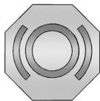
Ce symbole figure sur le bouchon du réservoir de liquide de frein/embrayage hydraulique. Le réservoir hydraulique commun de liquide de maître-cylindre d'embrayage et de frein est rempli
