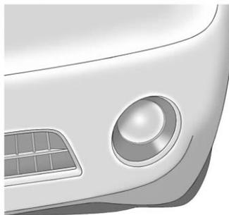
1. Repérer l'ensemble d'ampoule sous le carénage avant.
