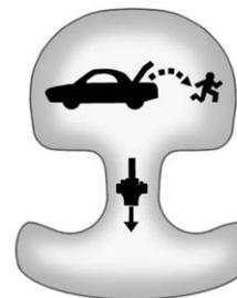
Une poignée de déverrouillage d'urgence du coffre se trouve sur le revêtement à l'intérieur du coffre, à proximité du loquet de coffre. Sur certains véhicules, on peut accéder à la poignée de déverrouillage en repliant le dossier de siège arrière vers le bas. Voir *Sièges arrière* à la page 3-6.
