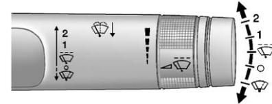
Le levier d'essuie-glace avant est placé sur le côté de la colonne de direction. Lorsque le commutateur d'allumage occupe la position ACC/ACCESSORY (accessoires) ou ON/RUN (en fonction/marche), déplacer le levier pour sélectionner la vitesse de l'essuie-glace.
