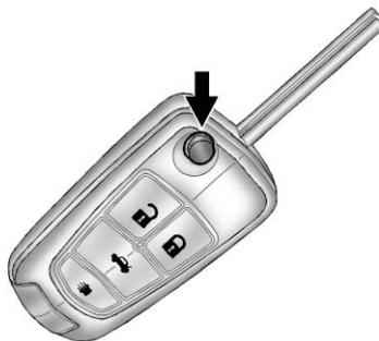
Appuyer sur le bouton de libération de clé (key release) de l'émetteur RKE pour sortir la clé. Appuyer sur le bouton et la lame de la clé pour la rentrer.
