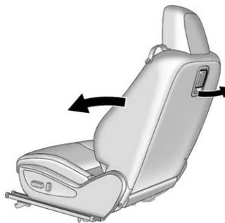
Pour accéder aux sièges arrière lever le loquet placé à l'arrière du dossier de siège de conducteur ou de passager avant. Replier le dossier de siège vers l'avant.
