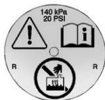
3. Couvrir le bouchon du radiateur avec un tissu épais, le tourner lentement dans le sens antihoraire et le retirer.
