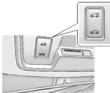
**Ouvrir/Fermer:** Presser et maintenir l'arrière ou l'avant du commutateur pour ouvrir ou fermer le toit ouvrant.
