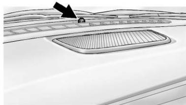
Le véhicule est doté d'un capteur de luminosité situé sur le dessus du tableau de bord. Ne pas couvrir le
