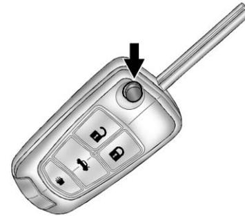
Appuyer sur le bouton de déverrouillage de la clé pour sortir la lame de la clé. La clé s'utilise dans le contact et toutes les serrures.
