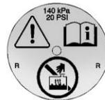
2. Couvrir le bouchon du radiateur avec un tissu épais, le tourner lentement dans le sens antihoraire et le retirer.
