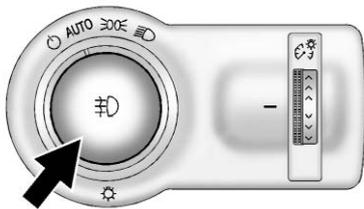
Sur les véhicules équipés de phares antibrouillard avant, le bouton se trouve sur la commande d'éclairage extérieur, du côté extérieur de la colonne de direction.
