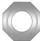
Ce symbole figure sur le bouchon du réservoir de liquide de frein/embrayage hydraulique. Le réservoir hydraulique commun de liquide de maître-cylindre d'embrayage et de frein est rempli de liquide de frein DOT 3 comme indiqué sur le bouchon. Voir *Aperçu du compartiment moteur à la page 10-6* pour l'emplacement du réservoir.
