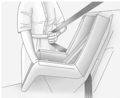
4. Tirer la ceinture diagonale à fond du rétracteur pour enclencher le verrouillage. Lorsqu'il est verrouillé, la ceinture peut être attachée mais non tirée du rétracteur.
