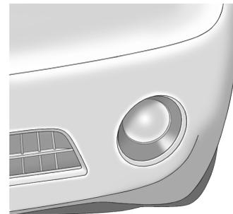
1. Repérer l'ensemble d'ampoule sous le carénage avant.
