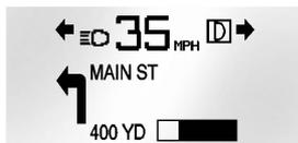
L'image du HUD affichée sur le pare-brise s'atténuera ou s'intensifiera automatiquement pour compenser l'éclairage extérieur. Cependant, la commande de luminosité du HUD reste disponible.
