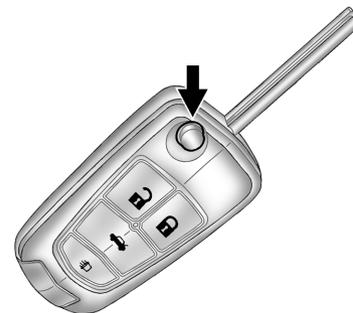
Presser le bouton de libération de clé de l'émetteur RKE pour sortir la lame de la clé. Presser le bouton et la lame pour rétracter la clé.
