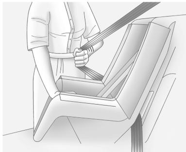
4. Tirer complètement la ceinture épaulière de l'enrouleur pour engager le système de blocage. Lorsque le système de blocage de l'enrouleur est réglé, la ceinture peut être serrée, mais ne peut pas être retirée de l'enrouleur.
