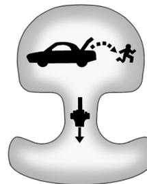
Une poignée de déverrouillage d'urgence du coffre se trouve à l'intérieur du coffre, sur le loquet. Sur certains véhicules, on peut accéder à la poignée de déverrouillage en repliant le dossier de siège de siège arrière. Voir *Sièges arrière à la page 3-7.*
