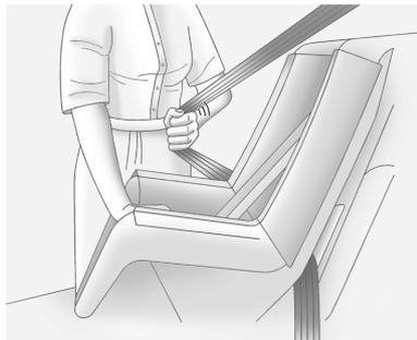
5. Tirer complètement la ceinture épaulière de l'enrouleur pour engager le système de blocage. Lorsque le système de blocage de l'enrouleur est réglé, la ceinture peut être serrée, mais ne peut pas être retirée de l'enrouleur.
