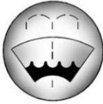
Enlever le bouchon marqué du symbole de lave-glace. Ajouter du liquide jusqu'à ce que le réservoir soit plein. Se reporter à *Aperçu du compartiment moteur* ↪ 308 pour connaître l'emplacement du réservoir.
