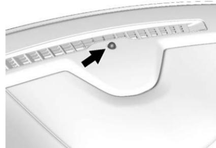
La sonde d'ensoleillement, sur le haut du tableau de bord près du pare-brise, surveille l'intensité du rayonnement solaire.
