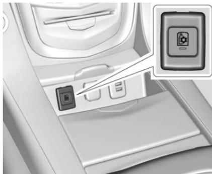
Selon l'équipement, presser pour activer le compartiment refroidi dans le rangement de la console centrale.
