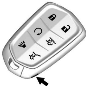
Appuyer sur le bouton situé sur le côté de l'émetteur RKE pour retirer la clé. Ne jamais retirer la clé sans appuyer sur le bouton.
