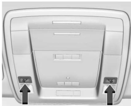
Des lampes de lecture sont logées dans la console de plafond et la garniture de pavillon, selon l'équipement. Pour les commander, le contact doit être mis ou sur ACC/ACCESSORY (accessoires), ou il faut utiliser l'alimentation prolongée des accessoires (RAP).
