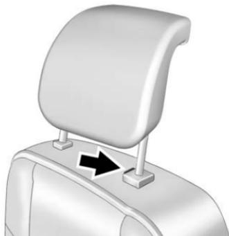
L'appui-tête du siège de troisième rangée peut être abaissé pour permettre une meilleure visibilité lorsque le siège arrière n'est pas occupé.
