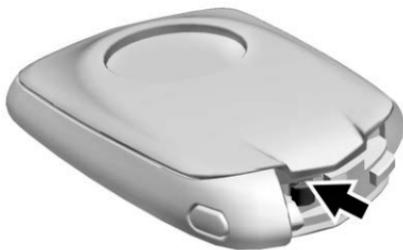
2. Séparer les deux moitiés de l'émetteur en utilisant un outil plat introduit dans le bas du centre de l'émetteur. Ne pas utiliser la fente de clé.
