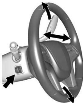
Pour régler le volant inclinable et télescopique à commande électrique :
