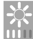
Chaque pression sur le bouton passe d'une configuration de luminosité à une autre, pour cinq configurations possibles.
