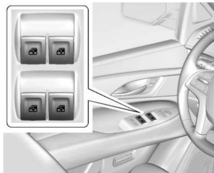
Les lève-glaces électriques fonctionnent lorsque le contact est mis, en position ACC/ACCESSORY (accessoires) ou lorsque la prolongation de l'alimentation des accessoires (RAP) est active. Se reporter à *Prolongation d'alimentation des accessoires* ⇨ 222.
