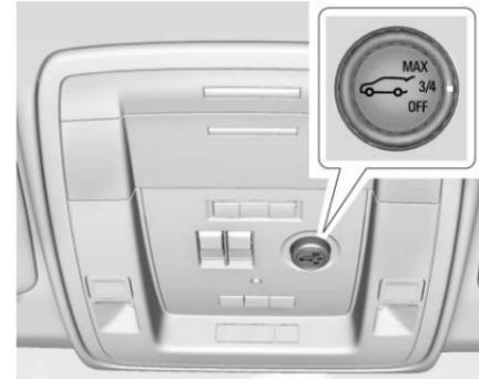
Le commutateur de hayon électrique est sur la console de plafond. Le véhicule doit être en position de stationnement (P).
