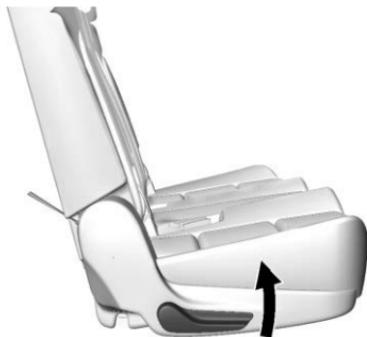
2. Lever le levier sur le côté extérieur du siège pour déverrouiller le dossier.
