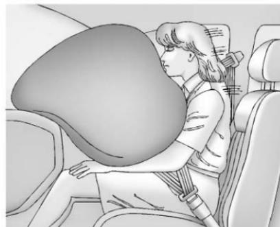
Le sac gonflable avant de passager avant extérieur se trouve dans le tableau de bord du côté passager.
