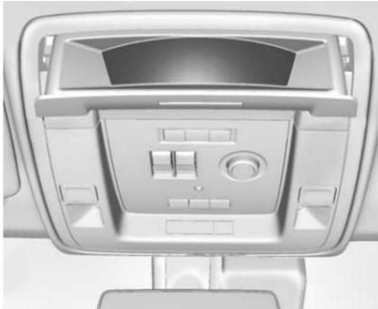
Selon l'équipement, le rétroviseur enfant se trouve dans la console de plafond. Appuyer sur le bouton fixe sur le couvercle pour le dégager. Remettre le rétroviseur en place lorsqu'il n'est pas utilisé.
