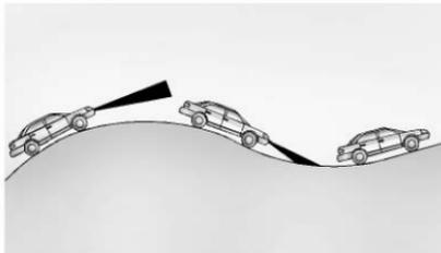
Ne pas utiliser l'ACC en côte ou en tractant une remorque. L'ACC ne détecte pas un véhicule dans la voie en roulant en côte. Le conducteur doit souvent accélérer et freiner en côte, spécialement en tractant une remorque. Si les freins sont appliqués, l'ACC est désengagé.
