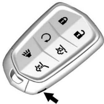
1. Appuyer sur le bouton situé sur le côté de l'émetteur RKE, près du bas, pour retirer la clé. Ne jamais retirer la clé sans appuyer sur le bouton.
