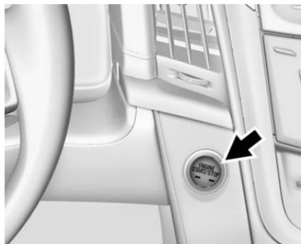
Le véhicule est équipé de l'accès sans clé et dispose d'un démarrage par bouton-poussoir.
