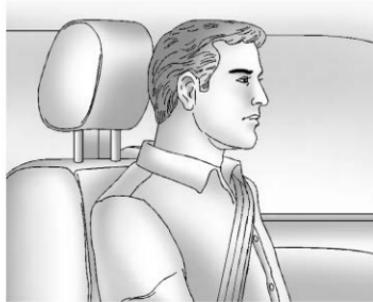
Régler l'appuie-tête de sorte que sa partie supérieure arrive au niveau du haut de la tête de l'occupant. Cette position réduit les risques de blessure à la nuque lors d'une collision.
