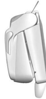
3. Tirer à nouveau sur la sangle pour libérer du plancher l'arrière du siège. Le siège se rabattra vers l'avant.
