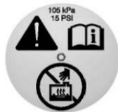
1. Retirer le bouchon de pression du réservoir d'expansion lorsque le système de refroidissement, y compris le bouchon de pression et la durite supérieure, ne sera plus chaud.
