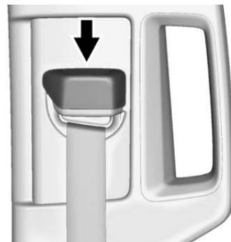
Enfoncer le bouton de déverrouillage pour déplacer le dispositif de réglage de hauteur à la position souhaitée.
