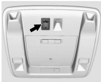
Il est recommandé de désactiver les capteurs d'intrusion et d'inclinaison si des animaux domestiques sont laissés dans le véhicule ou si le véhicule est transporté.
