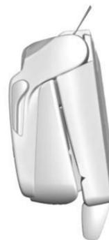
3. Lever ce levier à nouveau pour libérer du plancher de l'arrière du siège. Le siège se rabattra vers l'avant.
