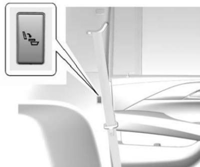
Commutateur sur le panneau arrière côté conducteur
